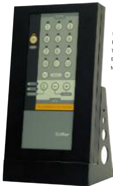
Передняя консоль Edifier Demo Unit позволяет переключаться между двумя источниками звука, регулировать громкость и подавать сигнал на 12 колонок
