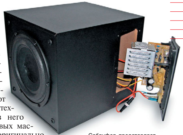
Сабвуфер представляет собой резонансную камеру с динамиком и трубой фазоинвертора. Внутри хватает места для блока питания и усилителей
